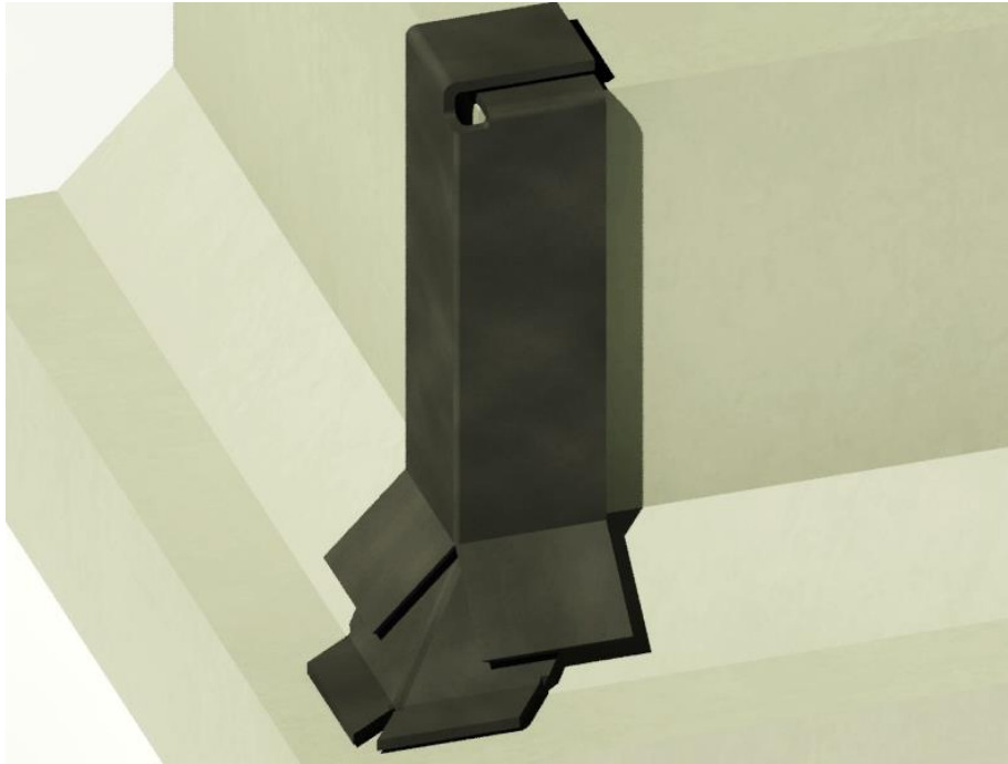
Мал.9. Посилення у вертикальній частині зовнішнього кута
