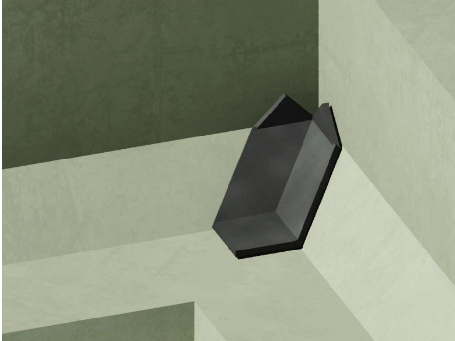
Мал.10 Посилення внутрішнього кута в зоні галтелі
