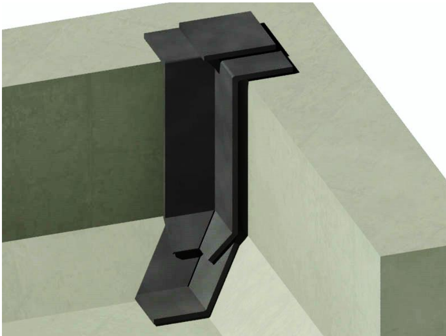
Мал.11 Посилення внутрішнього кута
