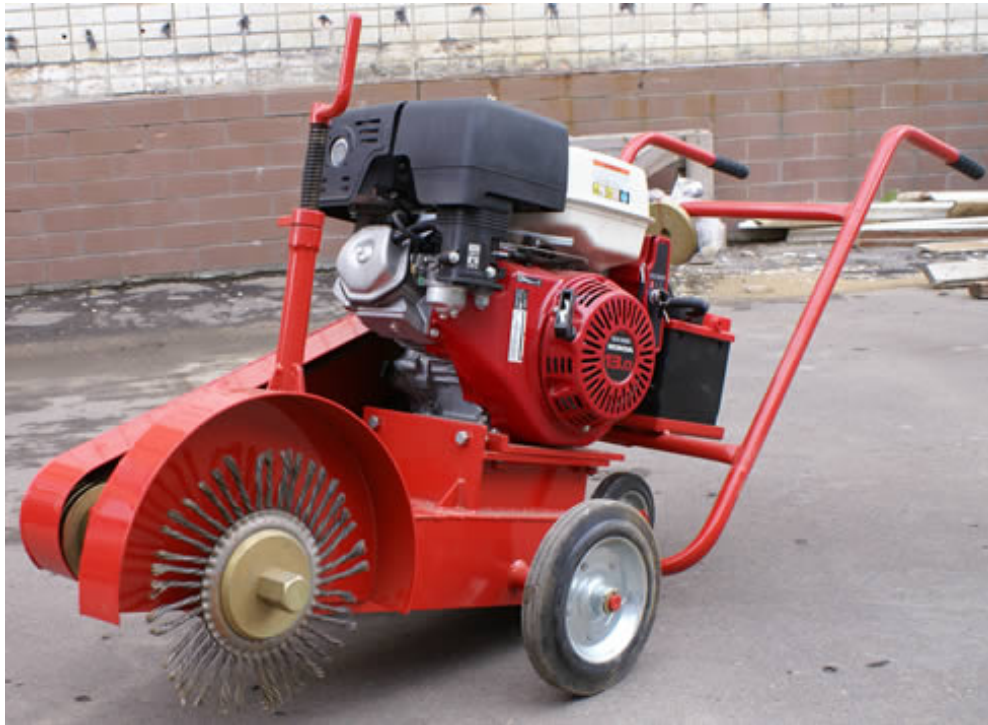
Мал. 4. Машина для розчищення швів та тріщин
